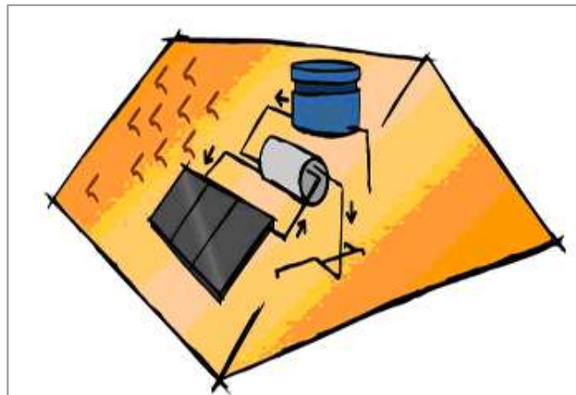
Figura 5 – Sistema de aquecimento solar
