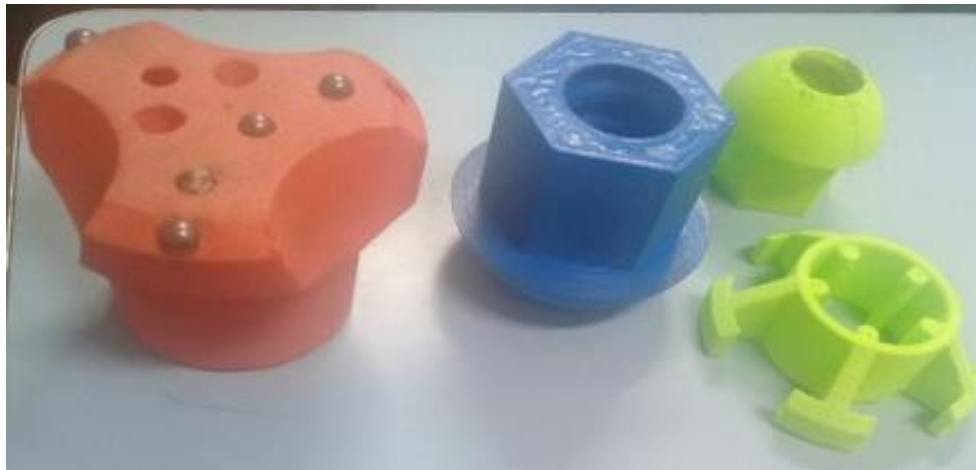
Figura 3: Moldes impressos em impressora 3D em ABS.
