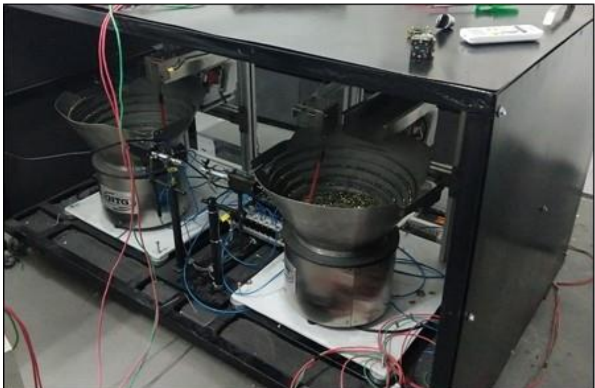
Figura 16 – Sistema de alimentação: Painel Vibratória.
