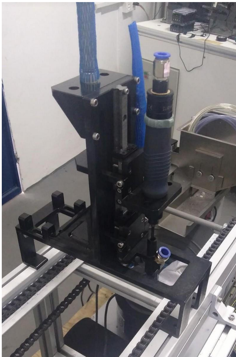
Figura 17 – Mecanismo principal: Torre de parafusamento.
