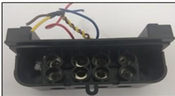
Bloco de terminais montado com os circuitos.
